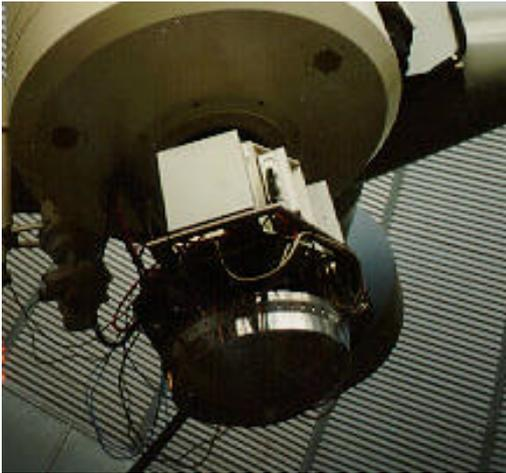
Fig. 3. The OGS 4k x 4k Pixel CCD-Camera
